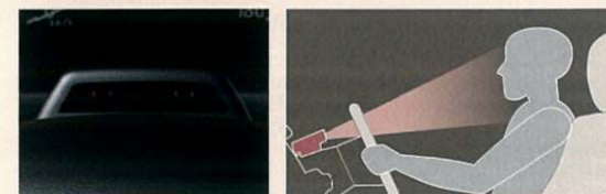
ドライバーモニターカメラ ドライバーモニターの作動イメージ
