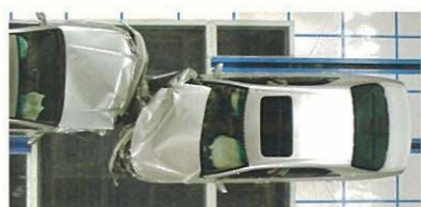
Car to Car SUV前面衝突実験 (50km/h 写真は実験用の試作車です)
