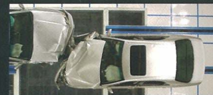
Car to Car SUV前部衝突実験 (50km/h 写真は実験用の試作車です)
