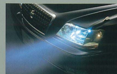
ディスチャージヘッドランプ (ロービーム) 通常のハロゲンランプに比べ、光量は2倍強。 つねに照射軸を一定に保つオートレベリング機能付です。
