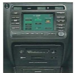
① クラウン・スーパーライブサウンドシステムEMV仕様インダッシュ6連奏CDオートチェンジャー&セット-AM/FMマルチ電子チューナーラジオ7スピーカー
