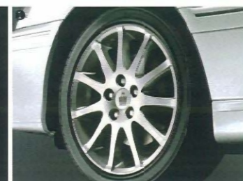
①メーカーオプション (フロント) 215/45ZR17-17x7.5JJアルミホイール (リヤ) 225/45ZR17-17x7.5JJアルミホイール ②アスリートG/アスリート 215/55R16 81V-16x6.5JJアルミホイール ③アスリートFour 225/55R16 81V-16x6.5JJアルミホイール
