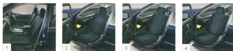
Photo: アスリーFour 全自動助手席回転スライドシート車「Bタイプ」。ボディカラーはブラッシュメタリックマイカ<3P3>。チルトとスライド電動ムーブアップ、寒冷地仕様はメーカーオプション。移動後乗客は必ず乗降口を閉鎖。
