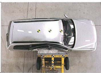
側面衝突実験 （55km/h、写真は実験用試作車です）
