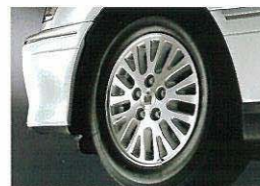
アスリートFour/ロイヤルサルーン 205/65R15 94H+ 15×6.5Jアルミホイール
