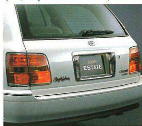
リヤフォグランプ ※リヤフォグランプを装着した場合、テールランプの点灯状態が変わります。
