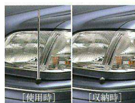
⑧フェンダーランプ(電動リモコン伸縮式)
