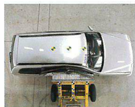
側面衝突実験(55km/h、写真は実験用試作車です。)
