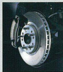
フロントベンチレーテッドディスクブレーキ
