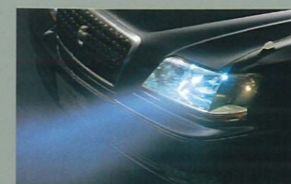
デイズチャージヘッドランプ (ロービーム) 通常のハロゲンランプに比べ、光量は2倍強。 ついに照射軸を一定に保つオートレベリング機能付です。
