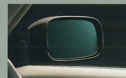
ワイドビューダミラー (ヒーター・レインクレンジングミラー・ブルーミラー) 雨天時の視認性確保に貢献するヒーター・付レインクレンジングミラー、防眩効果の高いブルーミラーを採用。 視認範囲を拡大する、広角のワイドビューダミラーとしました。
